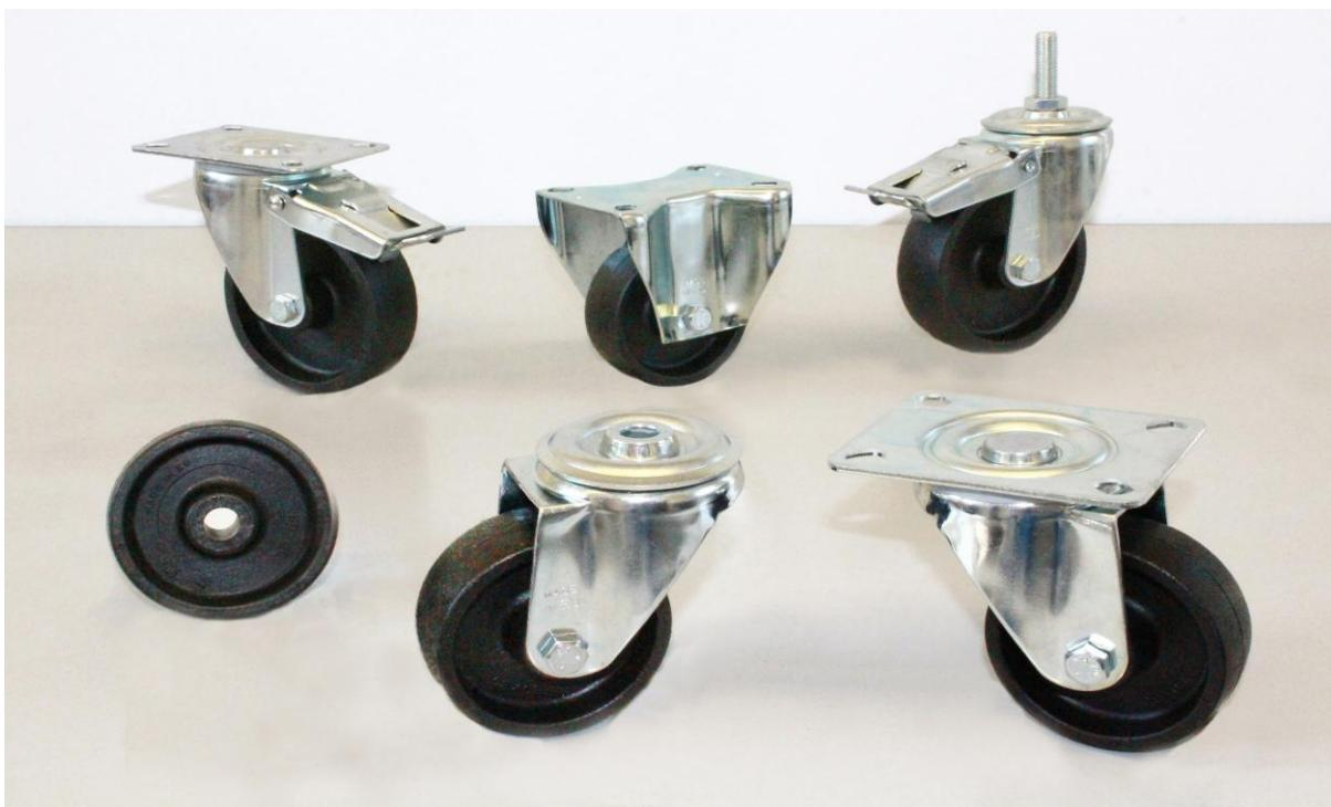
■ Ruota in tecnopoliomer carico con fibra di vetro per alte temperature. Viene utilizzata prevalentemente in industrie alimentari, forni di cottura, industrie farmaceutiche e chimiche ed industrie tessili. Queste ruote inoltre assicurano un'ottima resistenza agli urti, all'abrasione, alla maggior parte degli agenti chimici, agli oli ed ai grassi animali, garantendo inoltre una fortissima riduzione di rumore. Resiste a temperature da - 40° C a + 280° C. per brevi periodi.
